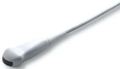
Микроконвексный неонатальный датчик CF4-9 (4-9 МГц, угол обзора 90°)
