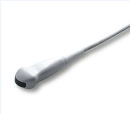
Микроконвексный неонатальный датчик CF4-9 (4-9 МГц, угол обзора 90°)
